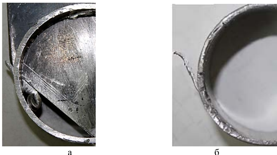
Рис. 6. Отделение отхода при резке трубы:
